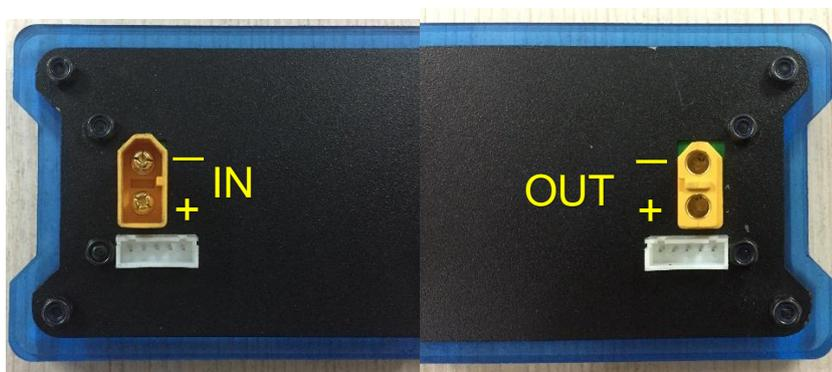
接口端子名称为 XT60，淘宝搜索“XT60”即可购买。照片上标注“IN”处接电池，标注“OUT”处接机器人。
