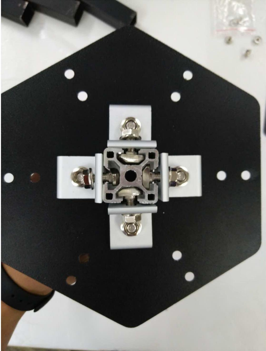
5. 用一个腿估计下固定板的大概高度，将下固定板上紧固定。将另一个固定板插入竖棍，用螺丝将腿和两个固定板上紧固定，如下图：
