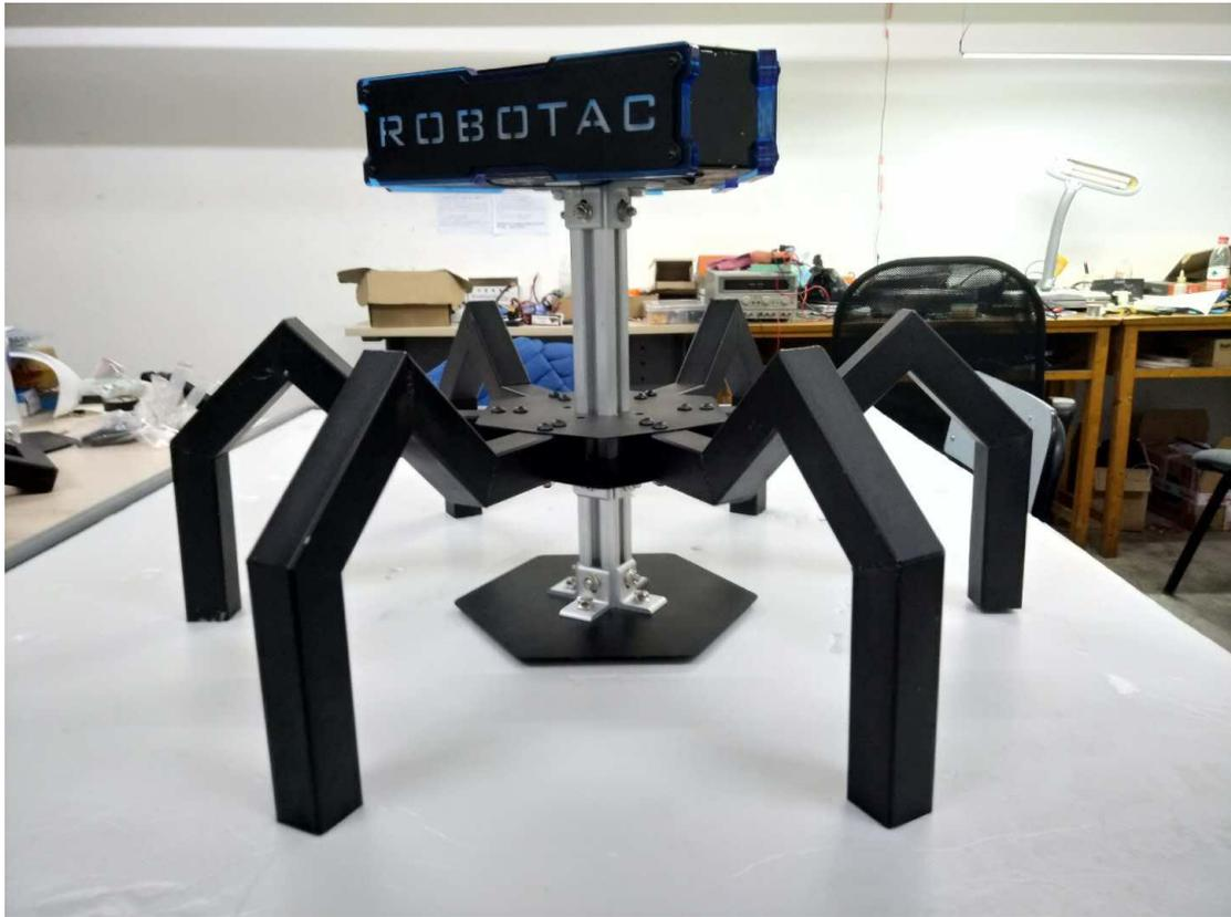
8. 打开老巢开关，进行 3s 开机自检。然后将橡胶球从老巢正上方 20-30cm 处丢下时，蜂鸣器和灯分别响 10 声，闪 10 下，表明老巢工作正常。
