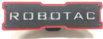
2019 年第十八届全国大学生机器人大赛 ROBOTAC 裁判系统道具, 机器人活力柱 / 生命柱。LED 显示有四种状态。常亮状态: 三格血满; 高亮度闪烁: 遭受一次有效击打; 低亮度闪烁: 遭受两次有效击打; 常灭: 遭受三次有效击打, 系统断电。
