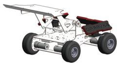
本实训课程讲解了气铲机器人的机械设计、运动控制、气铲控制原理。机器人支持多种底盘的搭配，例如标准尺寸轮毂底盘，超大尺寸轮毂底盘，仿生船足底盘。课程内容分为：应用场景需求分析，底盘运动学结构设计和控制原理、气铲式机械结构设计和控制原理，机器人应用对抗实践四个章节。机器人采用标准的 12V3S 锂电池供电，电流不超过 30A，尺寸不超过 567mm × 448mm × 243mm，重量 6kg，完全满足对抗气铲机器人制作学习和对抗实践要求。
