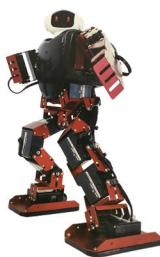
《人形机器人实训课》讲解了人形机器人的机械设计、运动控制原理。机器人由 16 个关节组成，可完成走路、转弯、翻跟头、踢足球等动作。机器人采用超高精度的舵机，使得动作十分精确敏捷。课程提供电脑控制软件以及机器人组装套件。
