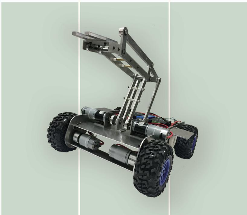
机械臂攻击机器人130/150采用轮式结构（轮直径分别为130mm、150mm），前端安装独臂攻击结构，配合两台直流有刷电机完成快速的“直拳”攻击动作，用户收到货后开箱即用。
