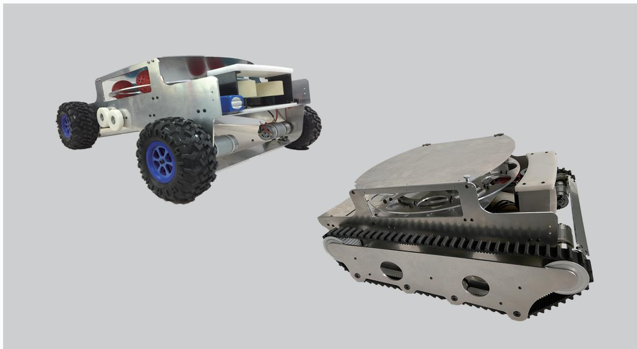
机器人采用轮式或履带结构底盘驱动，轮式结构机器人轻便，速度快。履带结构机器人稳重，射击稳定性高。机器人机构采用高精度铝合金拼接设计。机器人上方安装射击机构，配合两台直流无刷高速电机完成射击动作。机器人的底盘通过四台大功率行星齿轮直流减速电机提供动力，并配备6通道航模遥控器，2通道用于机器人运动控制，2通道用于机器人射击动作控制，留出2通道用于客户添加其他功能机构。功能完善，开箱即用。
